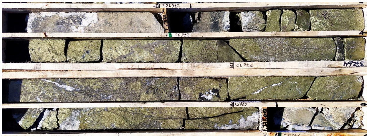
Figura 4 - Mineralización típica de una brecha rica en sulfuros de alta ley, en el sondaje SFDH-047: intervalo de tres metros de calcopirita masiva dentro de una brecha de calcopirita-pirita-cuarzo-turmalina. SFDH-047, 370 a 375,4 m. Incluye una muestra de 3m que promedió 18,98% de cobre, 2,7 g/t de oro y 431 g/t de plata. La fotografía es de un intervalo seleccionado y no es necesariamente representativa de la mineralización alojada en toda la propiedad.
