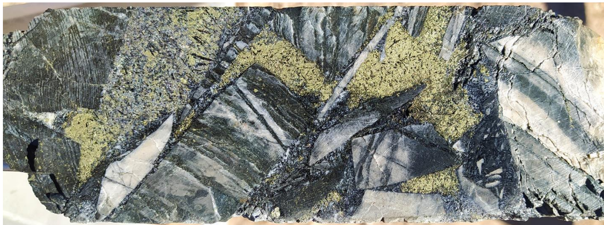
Figura 5 –Típica mineralización de brecha en el sondaje SFDH-044: Clastos de limolita alterados con turmalina-sílice en una matriz de calcopirita-pirita-cuarzo-turmalina. SFDH-044, 179,80 m. De una muestra de 1 m que promedió 1.2% de cobre, 57 g/t de plata y 0.03 g/t de Au. La fotografía es de un intervalo seleccionado y no es necesariamente representativa de la mineralización alojada en toda la propiedad.
