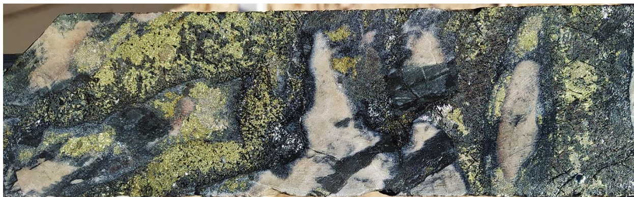
Figura 6 – Típica mineralización de brecha en el sondaje SFDH-045: Clastos de limolita alterados con turmalina-sericita en una matriz de calcopirita-pirita-turmalina. SFDH-045, 385,30 m. De una muestra de 1 m que promedió y 2.0% de cobre, 80 g/t de plata y 0.06 g/t de oro. La fotografía es de un intervalo seleccionado y no es necesariamente representativa de la mineralización alojada en toda la propiedad.
